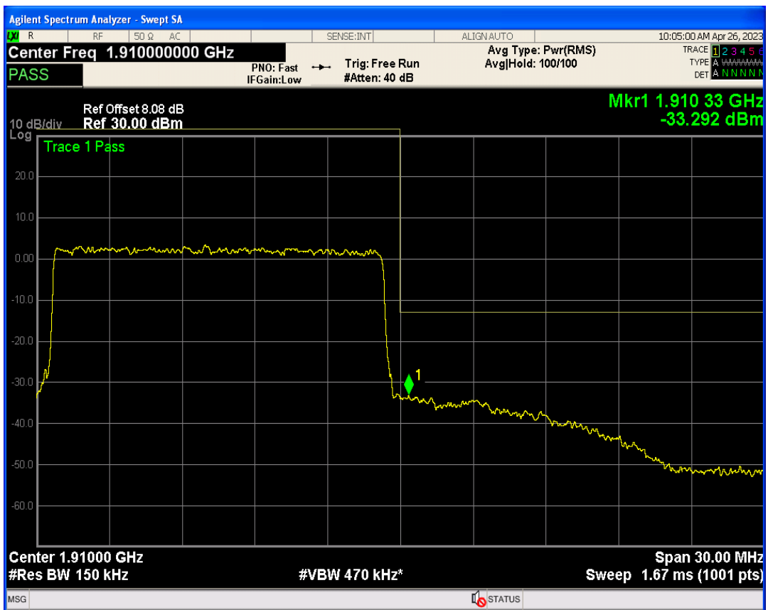
Band2 QPSK BW=20MHz Channel=18700 RB Size=1 Position=#0
