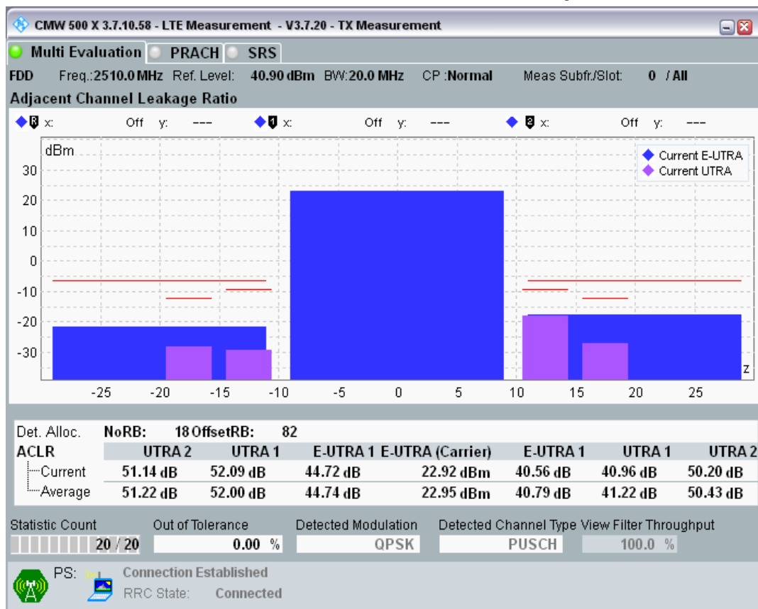
Band7 QPSK BW=20MHz Channel=21100 RB Size=100 Position=#0.png
