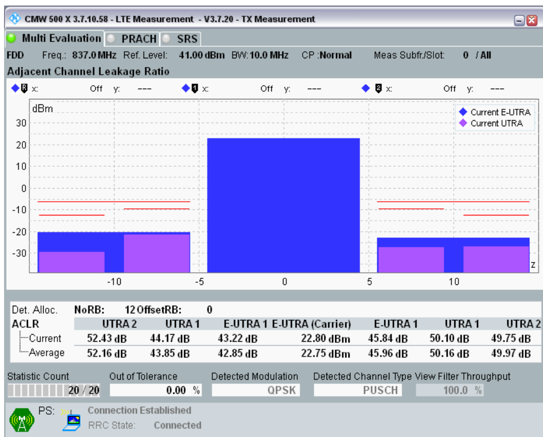
Band20 QPSK BW=10MHz Channel=24200 RB Size=12 Position=#Max.png
