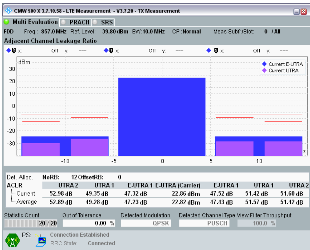
Band20 QPSK BW=10MHz Channel=24400 RB Size=12 Position=#Max.png
