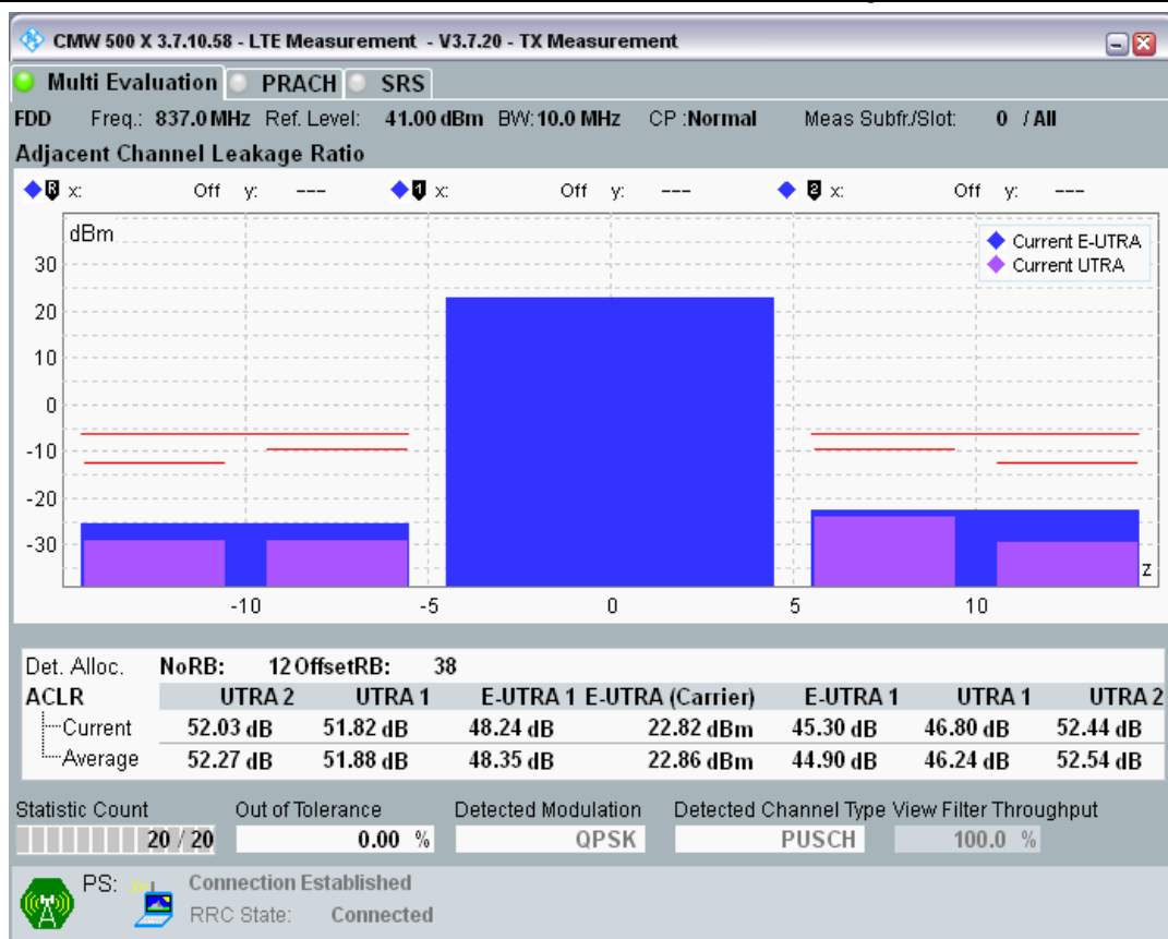
Band20 QPSK BW=10MHz Channel=24200 RB Size=50 Position=#0.png
