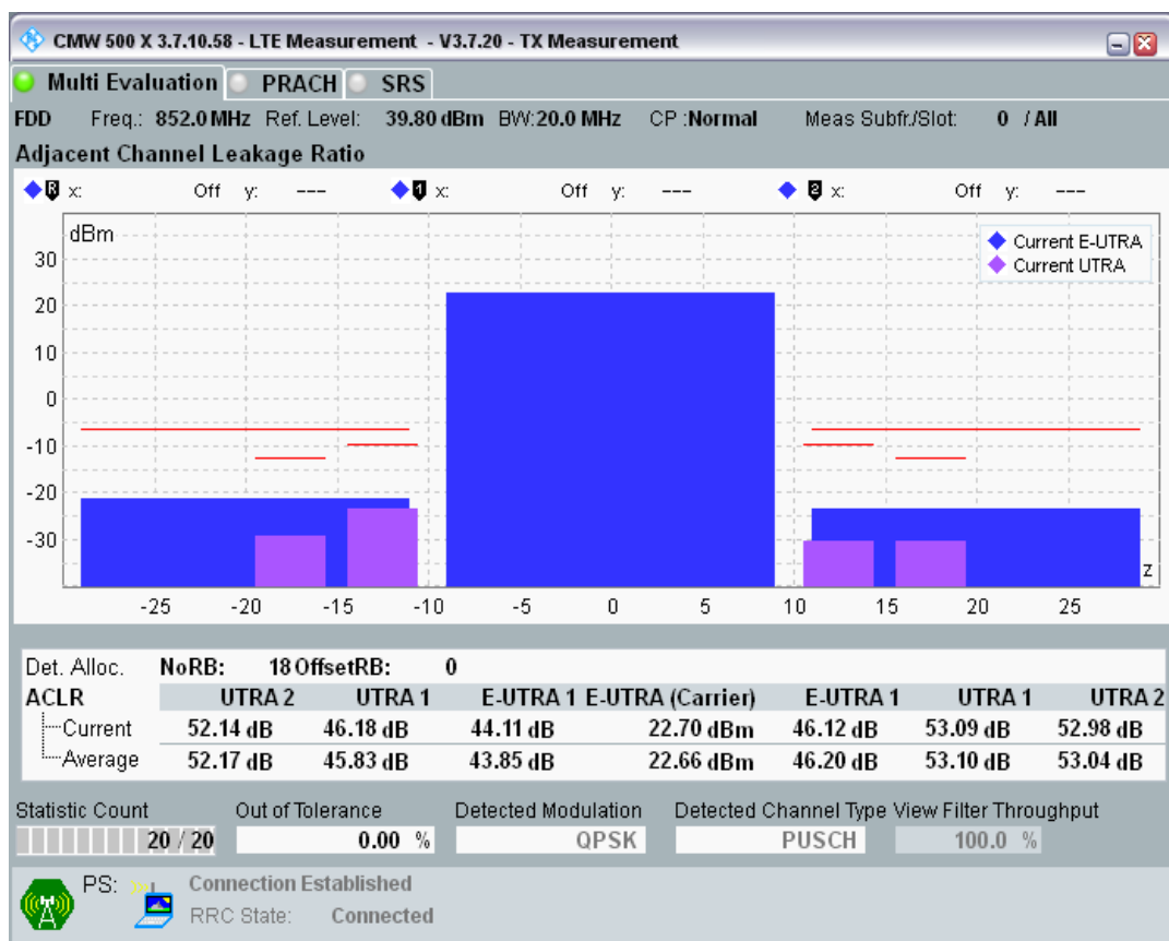
Band20 QPSK BW=20MHz Channel=24350 RB Size=18 Position=#Max.png
