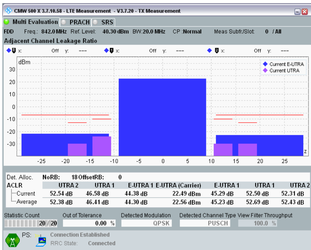
Band20 QPSK BW=20MHz Channel=24250 RB Size=18 Position=#Max.png
